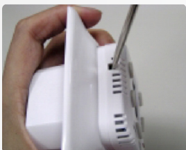
Incline hacia arriba para aflojar la parte del frente de los clips del gancho.
