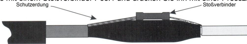
7. Platzieren Sie den Schrumpfschlauch  $\varnothing$  18 mm Pos. 4, sodass er die Verbindung vollständig bedeckt, und schrumpfen Sie ihn mit Heißluft. Der Schlauch sollte von der Mitte aus zu den Rändern hin erwärmt werden, sodass keine Luft im Inneren bleibt.
