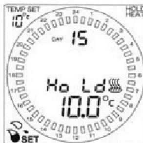
4. Sie können jederzeit zu der Programmsteuerung wechseln, indem Sie die "HOLD" oder ☺ Taste drücken.
