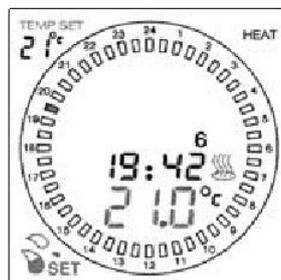
Der Überbrückungsindikator erscheint. In ca.10 Sekunden beginnt das Thermostat die Überbrückungsfunktion auszuführen. Die Kreisuhranzeige zeigt die gebliebene Zeit unter dem Überbrückungsmodus (die aktuelle Zeitanzeige blinkt).
