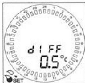
Um das Differential zu ändern, drücken und halten Sie die  $\odot$  und  $\nabla$  Tasten länger als 3 sec. Das Display zeigt jetzt die Differential-Einstellung.
